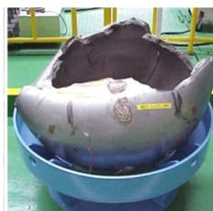
チタン製の耐圧球に圧力をかけて実験的に破壊した時は周囲を揺るがず爆音が響き渡ったとのこと。タイタニックのことなど連想したくありません。
